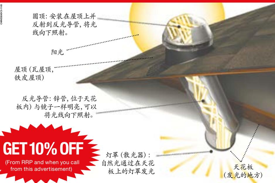
圆顶：安装在屋顶上并反射到反光导管，将光线向下照射。
